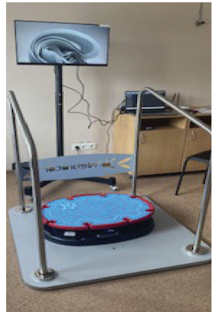
Система для анализа нервно-мышечной функции, с отслеживанием движения пациента
