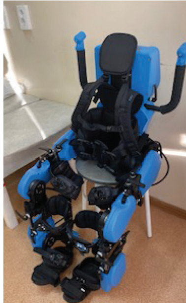
Роботизированный тренажер с биологически обратной связью для восстановления навыков ходьбы со встроенной синхронизированной системой
